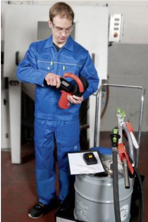
Rápida sustitución de la batería gastada por otra que espera en el cargador.
